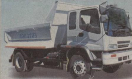
САМОСВАЛЫ на шасси «ISUZU» ГРУЗОПОДЪЕМНОСТЬЮ — 4,5 т или 9 т.
