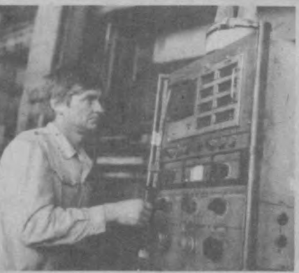
Токарь-карусельщик Владимир Минаев за работой на токарно-карусельном станке с пультом управления.
