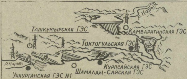
На снимках: схема освоения гидроэнергетических ресурсов реки Нарын. (Черные кружки — действующие ГЭС, светлые — строящиеся и проектируемые); возводятся очередная ступень Нарынского каскада — Таш-Кумырская ГЭС.
