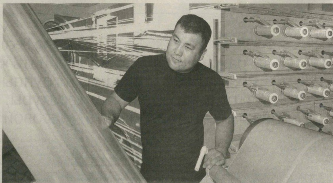
Столичное ООО "Hadicha Fayz Baraka" - одно из самых технологически оснащенных предприятий по изготовлению прочной промышленной упаковки - полипропиленовых мешков. Полный комплект оборудования предприятия включает в себя технологический экструдер для получения плоской нити из полипропиленовых гранул, ткацкие станки для изготовления готового полотна, а также резаки и швейные машины, замыкающие производственный процесс. Преимущество установленной производственной линии - компактность конструкции, высокая производительность и экономичное энергопотребление. Сотняные
