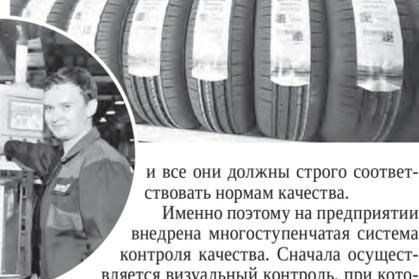
и все они должны строго соответствовать нормам качества. Именно поэтому на предприятии внедрена многоступенчатая система контроля качества. Сначала осуществляется визуальный контроль, при котором опытные операторы проверяют каждую шину на наличие более чем ста возможных дефектов. Затем осуществляется автоматический контроль. Если шина не прошла проверку, то у нее разрезается бортовое кольцо, что исключает попадание дефектной продукции на рынок.
