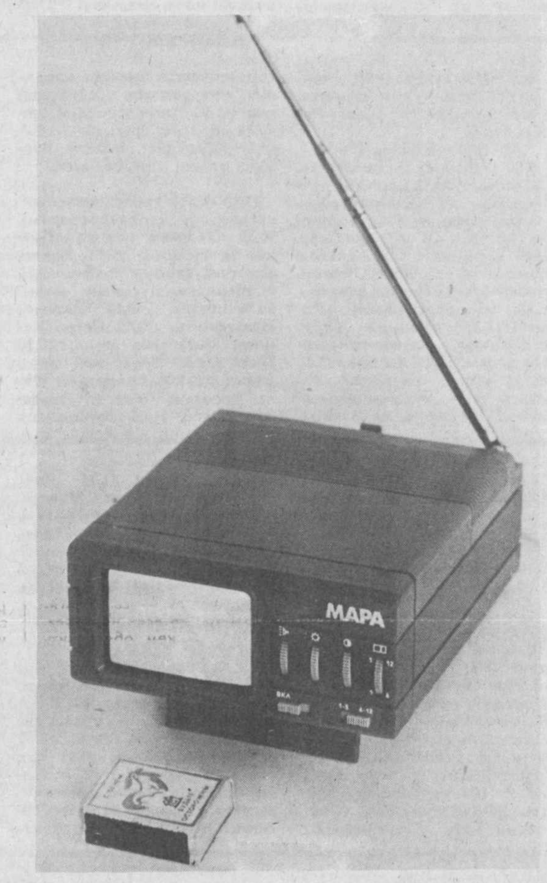
Малютку назвали «Мара» БЕЛУССКАЯ ССР. Самый маленький в стране черно-белый телевизор «Мара» («Мечта») выпущен минским заводом «Калибр». Он принимает три программы. Размер экрана по диагонали — всего восемь сантиметров. Работает телевизор не только от сети. Его можно смотреть и в автомашине. Подключив к так называемому «прикуривателю». Уже в нынешнем году предприятие могло бы производить ежемесячно по 500 штук. Но подводят поставщики комплек- тующих деталей с Украины, Литвы, Армении. НА СНИМКЕ: телевизор «Мара». Фото В. ВИТЧЕНКО. (Белта — ТАСС).
