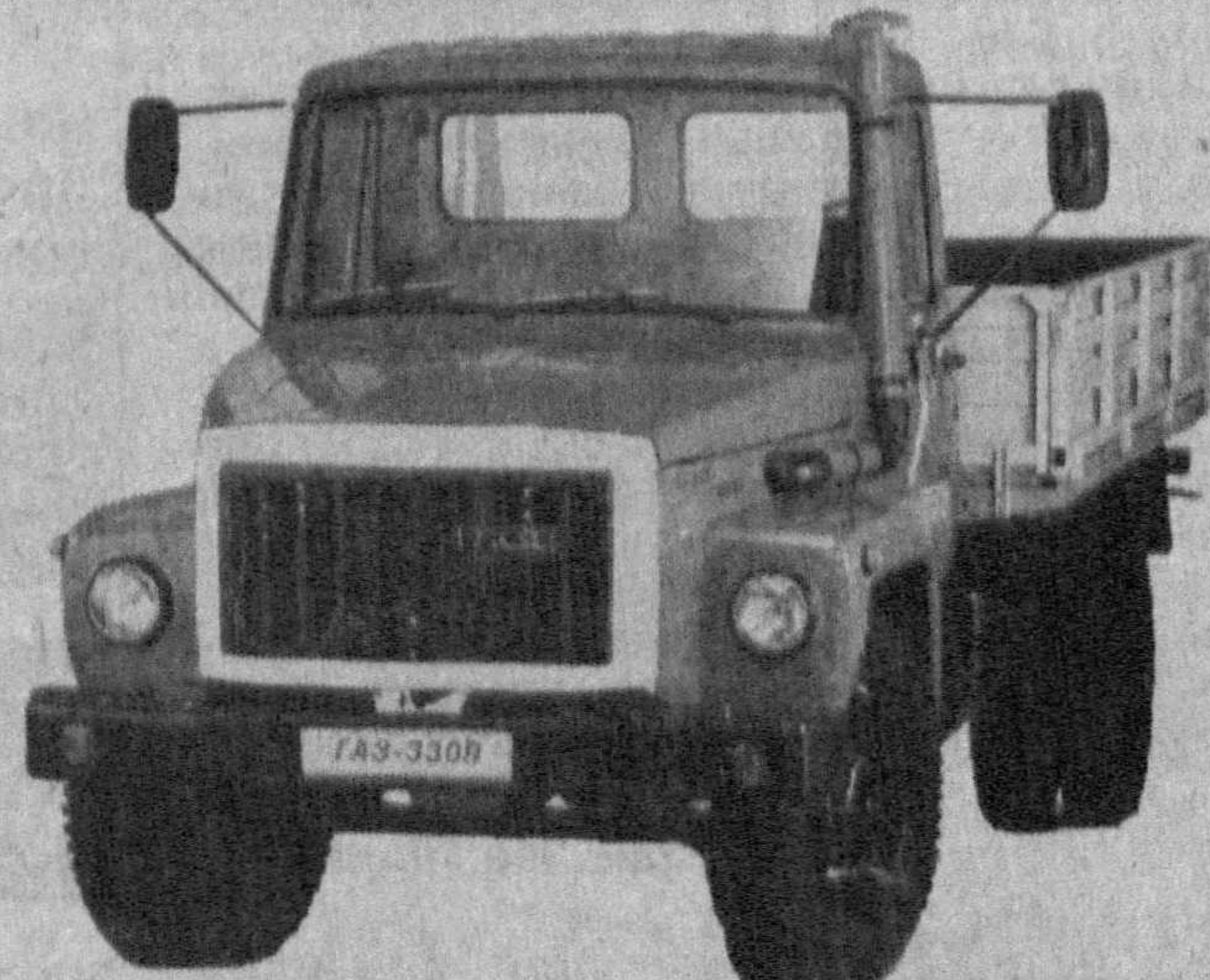
GAZ-3309 Турбодизель грузоподъемность - 4,5 т, количество мест - 2
