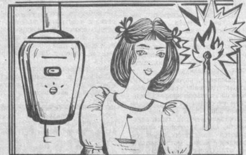
— после проверки наличия тяги под колпаком водонагревателя открыть кран на подающем газопроводе;
