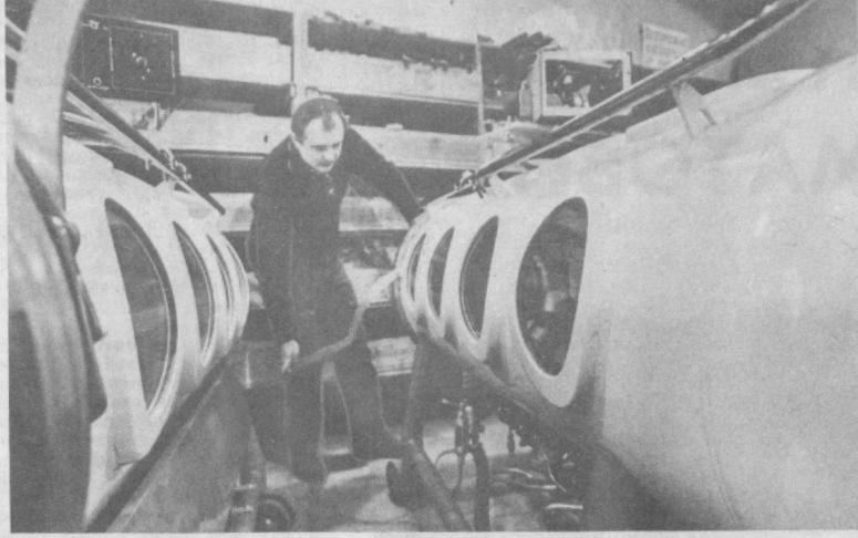
**ТАШКЕНТСКАЯ ОБЛАСТЬ** Производство одновременно изображенной установки для баронамеры, предназначенной для проведения инспираторного лечения человека от различных заболеваний, наложено на чирчикском производственном объединении «Средазхиммаш».
