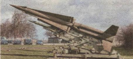
«Найк-Геркулес» комплексининг ишга тушириш қурилмаси стационар (кўчмас) ва шатакка олинувчи варианларда ишлаб чиқарилади. Улар бошқарилувчи зенит ракеталарнинг вертикаль равишида ишга туширилишини таъминлайди. Иккى поғонали «Найк-Геркулес» русумли бошқарилувчи ракета аэродинамик схема бўйича қурилган. Унинг старт оғирлиги 4500 килограмм, узунлиги 12,5 метр, корпус диаметри 0,8 метр, қанот кўлами 2,3 метр, максимал учиш тезлиги сониясига 1100 метрни ташкил этади.
