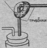
Магнит способен помочь не только, скажем, достать железную пробку, упавшую в сосуд, наполненный жидкостью, или отыскать затерявшуюся в мусоре гайку, но и достать опилки из отверстия в детали, которую нельзя перевернуть, чтобы вытряхнуть эти опилки после сверления или нарезки резьбы.
