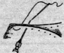
• Резать пенопласт очень удобно с помощью электрического паяльника. Предварительно жало паяльника надо расплющить, чтобы получилась лопаточка. При таком способе получается ровный срез и крошки пенопласта не оплавляются.
