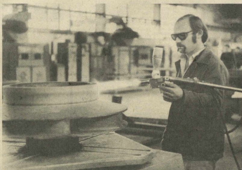
Оператор Игорь Гусев с помощью пистолета газотермического напыления упрочняет рабочее колесо насоса.
