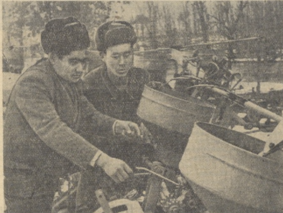
СУРАТДА: Янгиёул районидари Сталин номи колхоз механизми Йўлдош Охунва ва универсалчи Марат Ким квадрат-уялаб чиғит экинган селликни ремонт қилмоқдалар.
