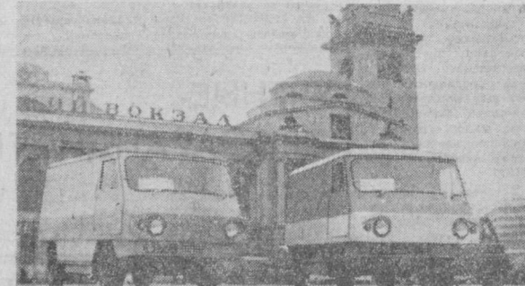
МОСКВА. Коллективом Всесоюзного научно-исследовательского института электромеханики сконструирован опытный образец электромобиля. Подарящая аккумуляторы производится от сети переменного тока городской электросистемы. Электромобиль развивает скорость до 60 км в час.
