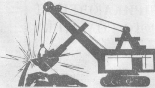
Требуйте от прорабов выдачи наряда на ведение земляных работ с отметкой об отсутствии электрокабелей на строительной площадке!
