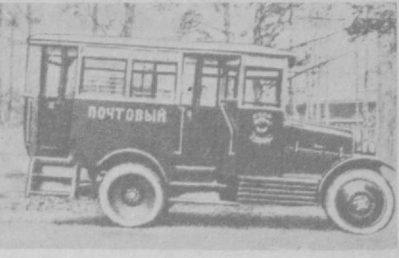
НА СНИМКЕ: первый советский автобус на базе «АМО-Ф-15». Рабочий объем — 4,396 куб. см. Мощность — 35 л. с. Длина — 5,2 м. Скорость — 42 км в час. Мест для сидения — 14.
