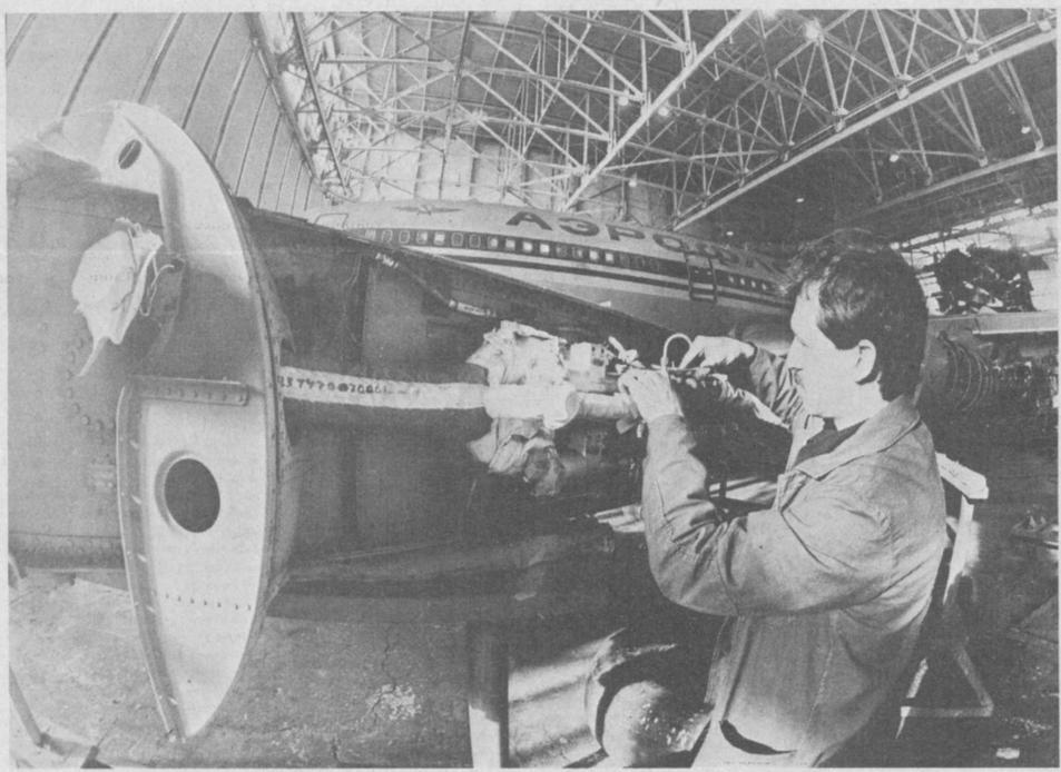
**ТАШКЕНТ.** Коллективу Ташкентского авиаремонтного завода впервые поручено проводить повышенное техническое обслуживание авиалайнеров ИЛ-86. Здесь внедрили новый метод ремонта этих самолетов — «ТО-10000»: через десять тысяч летных часов он становится на обслуживание. Ремонтируются детали и агрегаты и параллельно проверяются работоспособность; если есть необходимость, их передают в ремонт.
