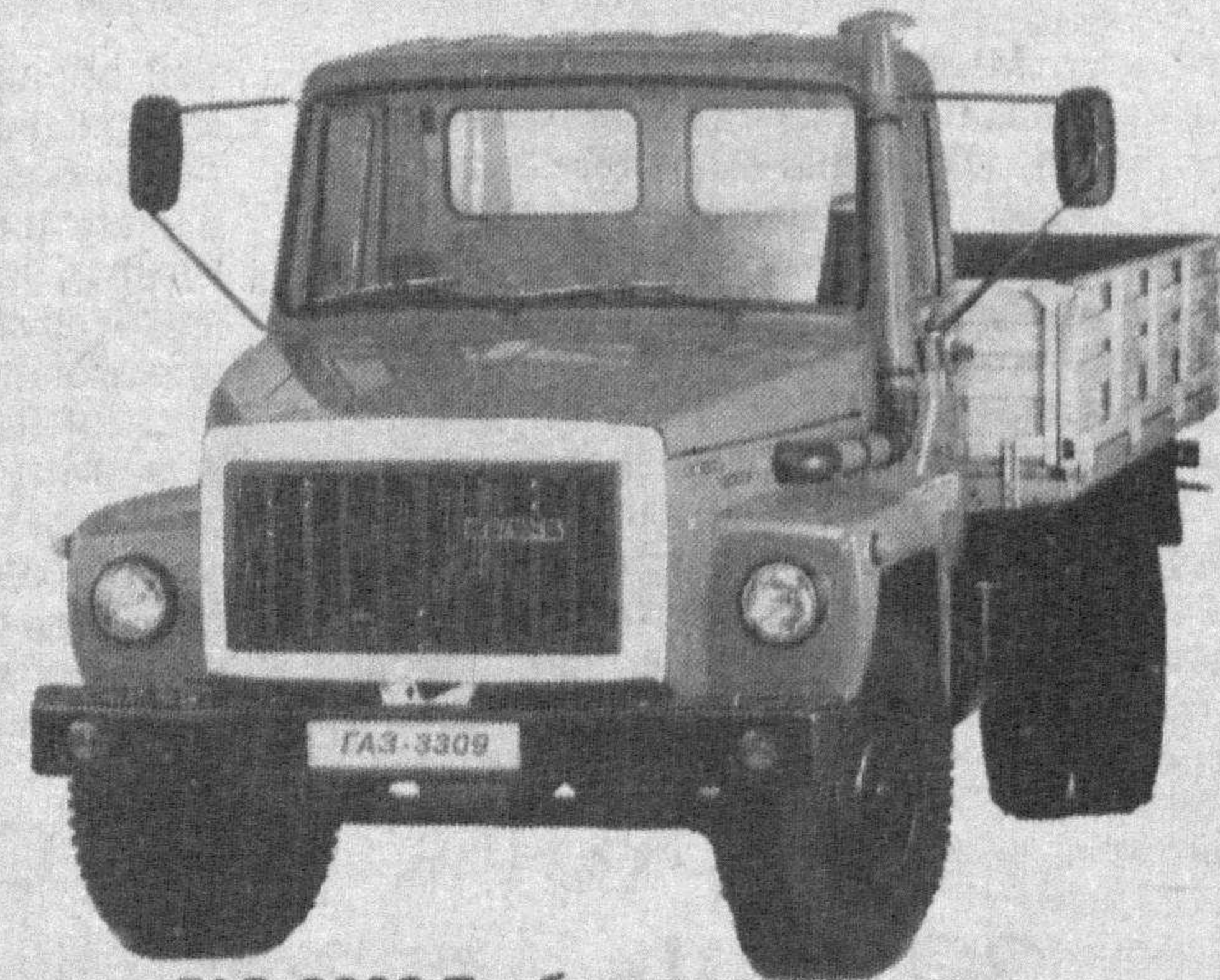
GAZ-3309 Турбодизель грузоподъемность - 4,5 т, количество мест - 2
