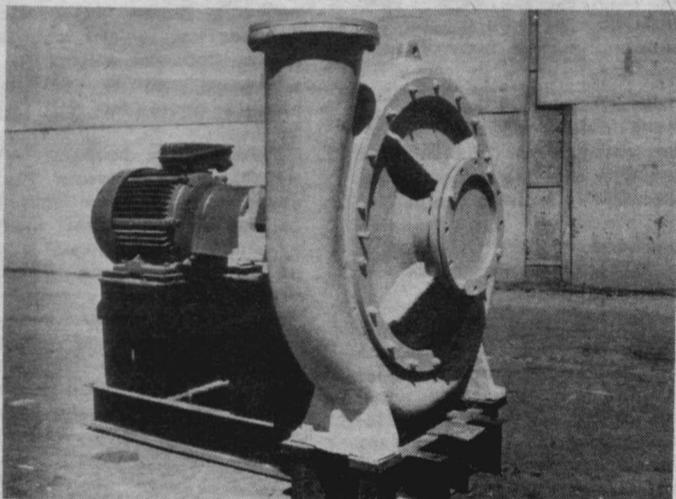
Завод изготавливает водокольцевой вакуумный насос ВВН-25М1, предназначенный для отсасывания воздуха или инертных газов, нерастворимых в воде.
