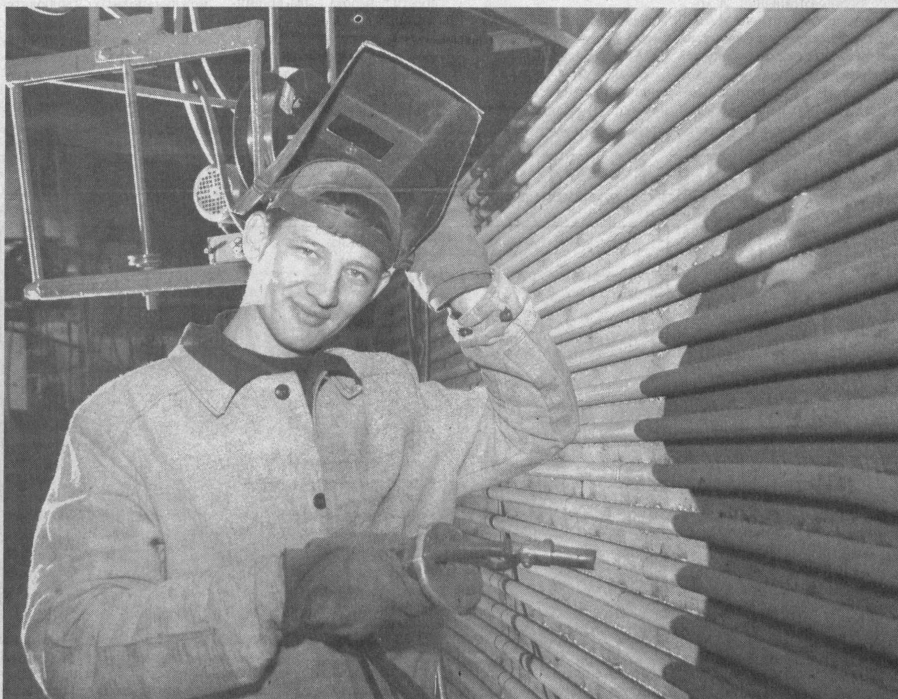
Хорошо зарекомендовали себя на ОАО "Алматынский ГМК" котлы-утилизаторы Ташкентского пусконаладочного производственного управления АО "Средазметэнерго". Они утилизируют горячие отходящие газы, преобразуя их в дешевое тепло, защищают воздушный бассейн и прилегающие территории от вредных выбросов.
