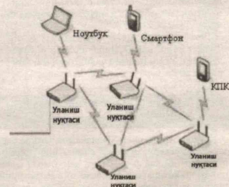
3-расм. MESH-топологияси бўйича тармоқни ташкил этиш.
