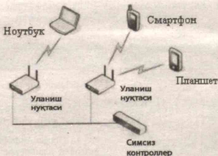
2-расм. Фойдаланув нукталарини битта контроллер бошқарадиган тармоқ ташкилотининг демарказлаштириш схемаси.
