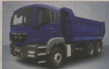
Автосамосвал MAN шассисид (юк кўтариш имконияти 20-25 тонна);
