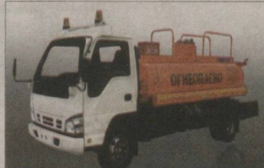
Ёнилғи ташиш машинаси (автобен- зовоз) ISUZU шассисда, идишининг сигими 4 тонна;
