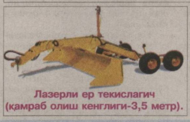
Лазерли ер текислагич (қамраб олиш кенглиги-3,5 метр).
