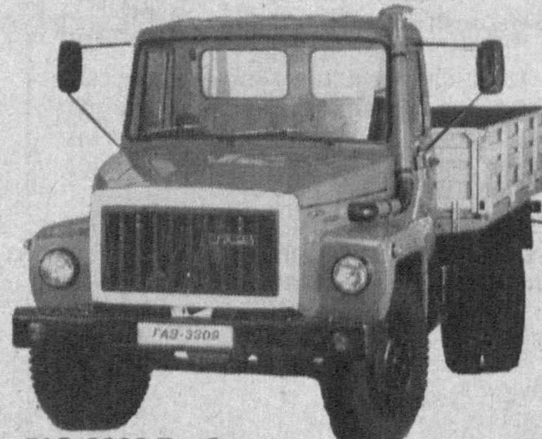
ГАЗ-3309 Турбодизель юк кўтариши — 4,5 тн., 2 ўриндиқли
