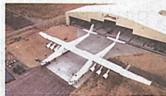
Его создатели - американская венчурная аэрокосмическая компания "Stratolaunch Systems" - уже провели ряд успешных испытаний, в том числе скоростных. Scaled Composites Stratolaunch Model 351 способен подняться на околоземную орбиту 6,12 тонны.
