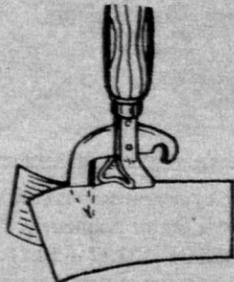
Кромку листового железа после разреза ножницами или консервным ножом можно зачистить самодельным стругом, изготовленным из куска старого ножовочного полотна. Угловой вырез в полотне делается на абразивном круге или с помощью трехгранного напильника. Не забудьте заточить рабочие грани струга.
