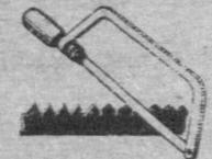
Чтобы при заточке ножовки зубья ее получались острыми и имели правильную форму, зажмите полотно ножовки в тисках и сделайте между зубьями небольшие пропилы. Только после такой процедуры можно приступить к работе напильником.
