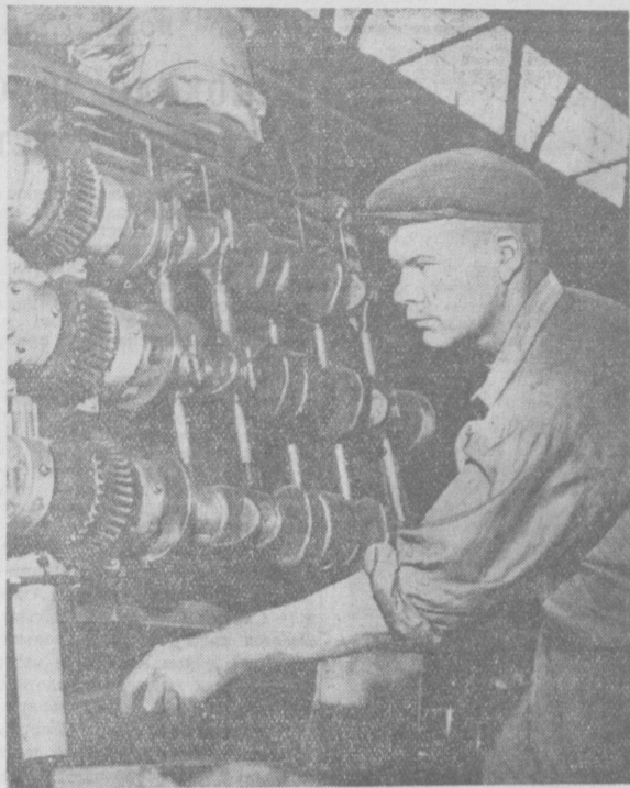
Готовя достойную встречу Пленуму ЦК КПСС, рационализаторы Ташкентского авторемонтного завода № 1 сконструировали и изготовили станок для однокрепной шлифовки и полировки шеек коленчатых валов двигателей автомобилей «ГАЗ-51» и «М-20». При отличном качестве продукции наклонного вала производительность труда на ШИМКЕ шлифовщика Геннадия Бочкарева за работу на новом станке. Он ежедневно выполняет по две нормы.
