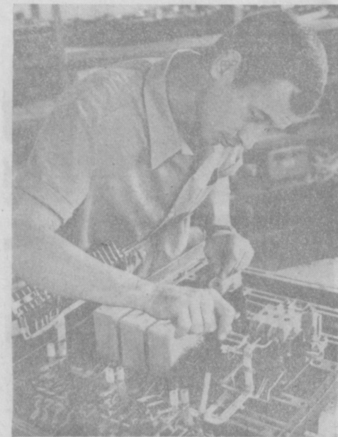
Экспериментальный участок андийского завода «Электроаппарат» приступил к изготовлению опытных шкафов, предназначенных для водопроводных и канализационных сооружений строящихся хлопкоочистительных заводов. Новшество позволит полностью автоматизировать управление этими сооружениями. На снимке: инженер-конструктор Равиль Гилзев ведет монтаж нового опытного шкафа.
