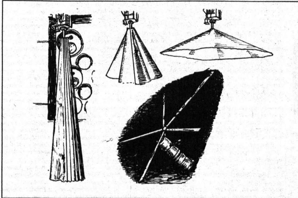
Этап этот был завершен в ноябре 1986 года наземным экспериментом по разворачиванию тонкопленочного полотна зеркального отражателя диаметром пять метров под действием центробежных сил в вакуумной камере Центрального НИИ космической отрасли.
